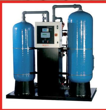
ha alcune effetto sulla salute. I sistemi di addolcimento più diffusi sono i dosatori a scambio ionico, filtri con speciali resine impregnate di ioni di sodio: al passaggio dell'acqua innescano un processo chimico che trattiene gli ioni di calcio e magnesio e rilascia gli ioni di sodio.
